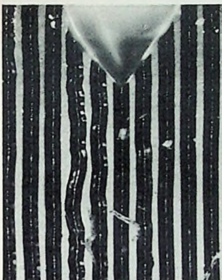
Bild 1. Mikrofotografie einer Schallplatte vor der Reinigung
